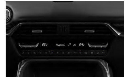
Climatisation trizone automatique
